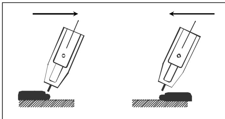
Pouze při sváření klesajícího svaru směrem dolů se hořák drží v neutrální nebo mírně „tahací“ poloze. Svislé sváření směrem dolů se používá nejvíce pro tenké plechy, u silnějších plechů vzniká riziko špatného propojení, protože tavenina stéká podél spoje a předbíhá svar, zejména pokud je tavenina příliš tekutá v důsledku vysokého napětí. Takový postup vyžaduje značný stupeň odbornosti a zkušenosti (viz obr. 18 A).
